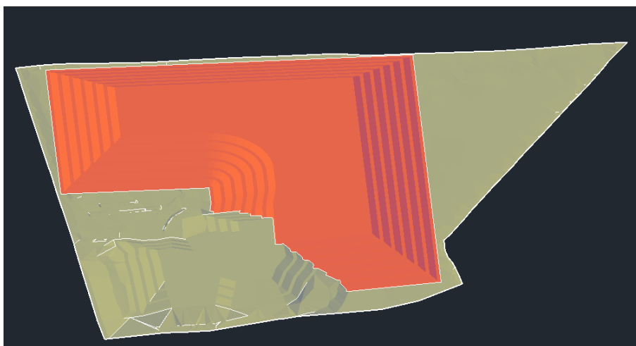
14Figura 2.14 Terrazas de ampliación de relleno sanitario en color rojo de Alternativa A [Gordillo & Zavala, 2020]
