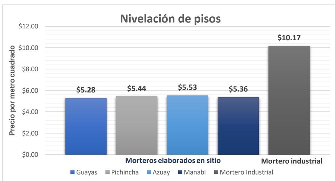
**Gráfico 3.18 Comparación de precio por metro cuadrado entre utilizar un mortero preparado en sitio y un mortero industrializado al realizar la nivelación de un piso, en las provincias con el mayor registro de construcciones [Gráfico elaborado por la autora]**
