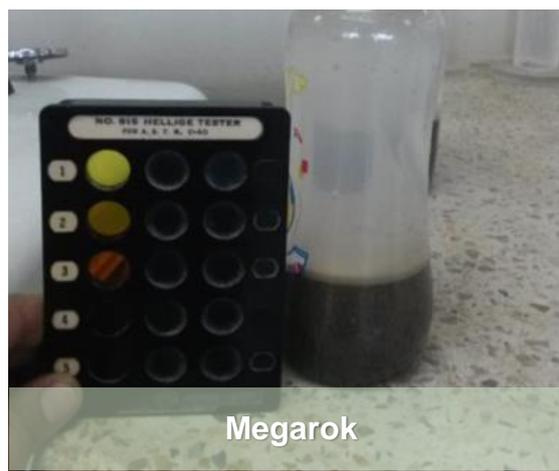
**Ilustración 3.2 Ensayo de Colorimetría realizado con los agregados procedentes de la ciudad de Manta [Saldarriaga, 2016]**
