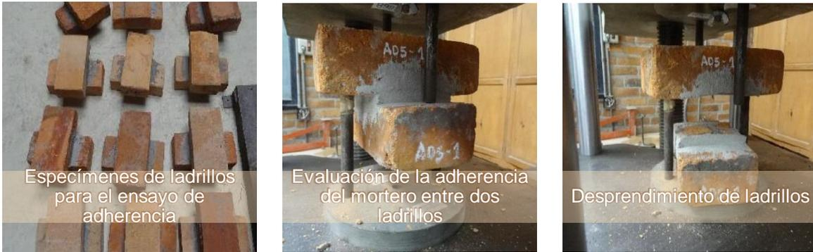
**Ilustración 3.6 Visualización del proceso que conllevó el ensayo de adherencia de los morteros fabricados con agregados procedentes del río Zamora [Zaruma, 2018]**
