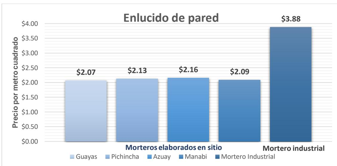
**Gráfico 3.19** Comparación de precio por metro cuadrado entre utilizar un mortero preparado en sitio y un mortero industrializado al realizar el enlucido de una pared, en las provincias con el mayor registro de construcciones [Gráfico elaborado por la autora]
