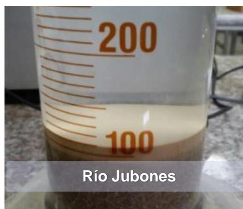
**Ilustración 3.3 Ensayo de Colorimetría realizado con los agregados procedentes de la ciudad de Cuenca [González J. F., 2016]**
