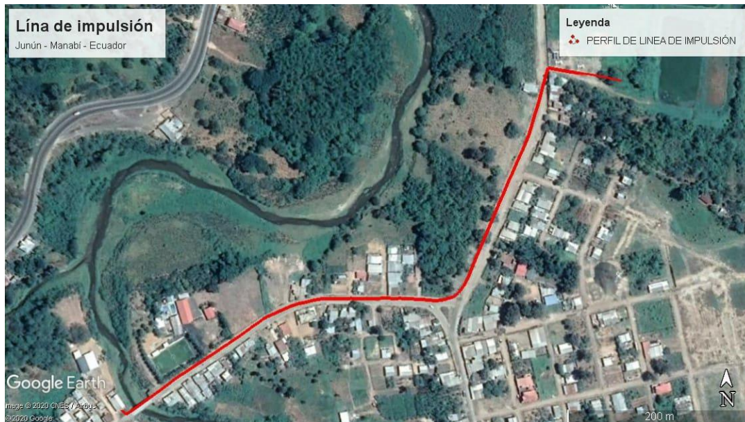
Figura 3.1 Trazado de nueva ruta de línea de impulsión con perfil de elevación del terreno
