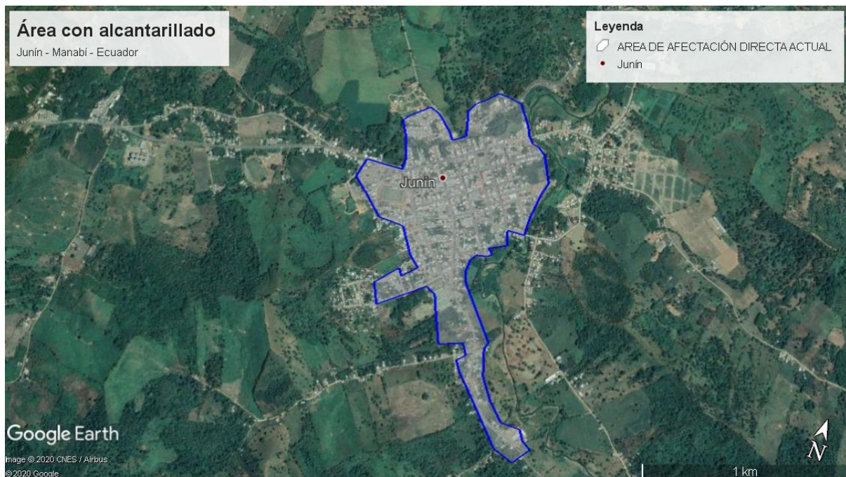
Figura 1.12 Áreas con cobertura de alcantarillado sanitario actual
