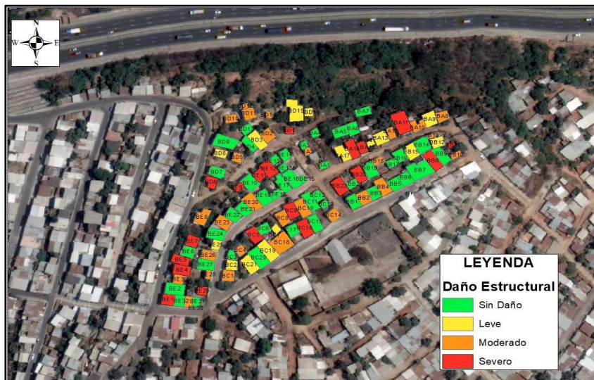
Figura 1.14 Daño Estructural viviendas de Bastión Popular [González & Loja, 2019]
