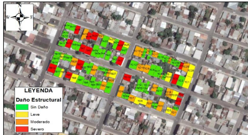
Figura 1.15 Daño estructural viviendas de la Isla Trinitaria [González & Loja, 2019]
