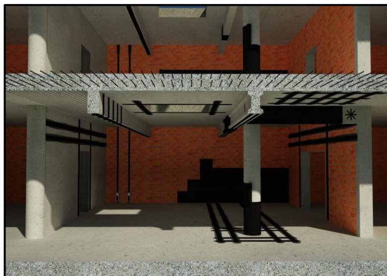
Figura 2.5 Placas de polímeros reforzados con fibra de carbono [SIKA, 2012]
