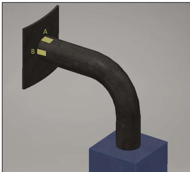
Figura 2.32 Ubicación de los puntos críticos para el análisis de soldadura.
