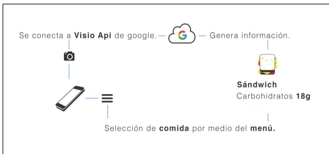
Figura 1. Diagrama de funcionamiento de la aplicación
