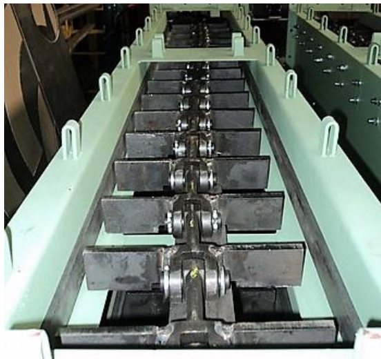
Figura 2.5 Transportador Redler de cadena simple (Fuente: Tomado de https://woodpellet.in/products/redler )
