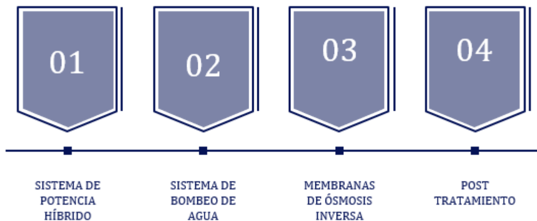
Figura 2.1 Proceso general del sistema de desalinización
