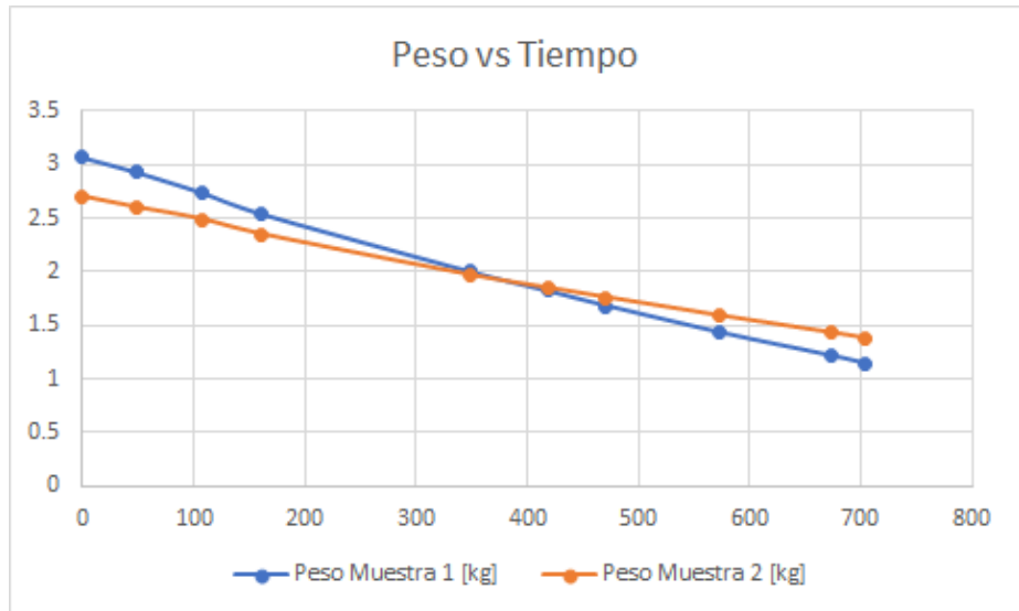
Figura 2.5 Gráfico de ritmo de sublimación en el tiempo de las dos muestras de hielo seco.
