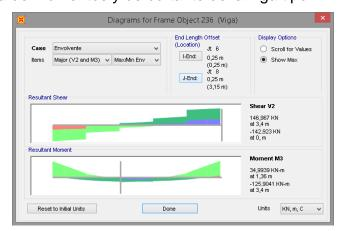
Figura 3.23. Diagrama de momento y cortante - Viga tipo 1.
