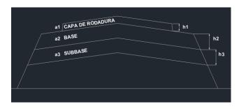
Figura 3.42. Esquema gráfico para la ecuación del número estructural
