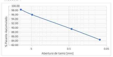
Figura 2.12 Curva granulométrica de la muestra 1
