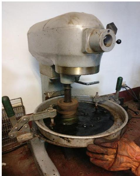
**Figura 1.6.3 Ensayo de abrasión durante 6 minutos. Fuente: Propia.**
