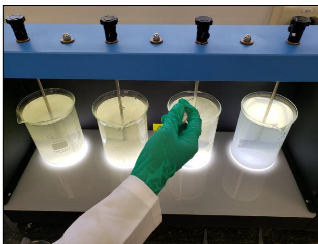
Figura 3.12 Aplicación de lechada de cal
