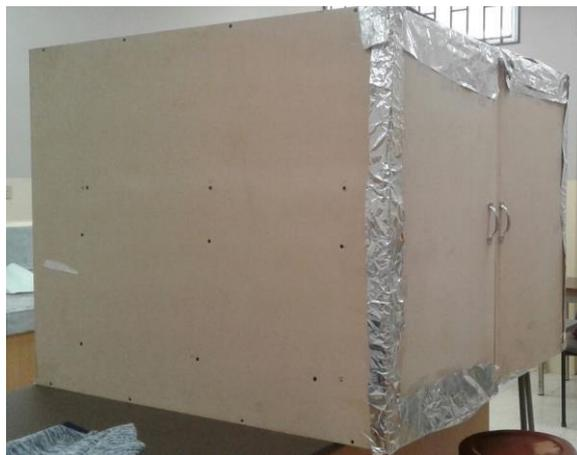
**Figura 3.5. Cámara de luz UV-C terminada vista externa y forma correcta de uso.**
