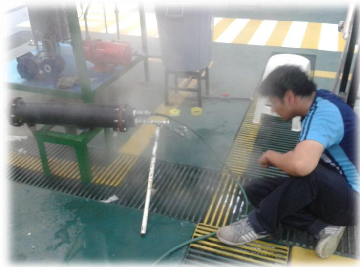
Figura 19. Sistema improvisado para probar el intercambiador de calor destinado a calentar la mezcla etanol-agua.
