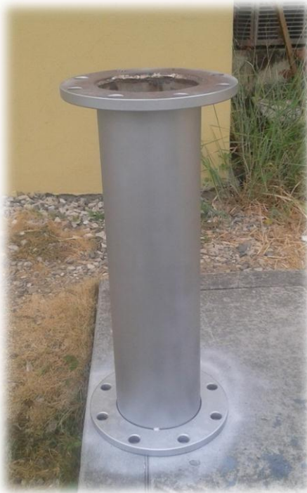
Figura 68. Tamiz molecular pintado. Fuente: (Pactong, Solange; Salinas, Marcelo.)
