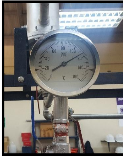
Figura 40. Termómetro indicando la temperatura del tamiz molecular.
