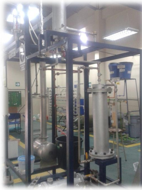
Figura 24. Tamiz molecular con sus líneas para regeneración.
