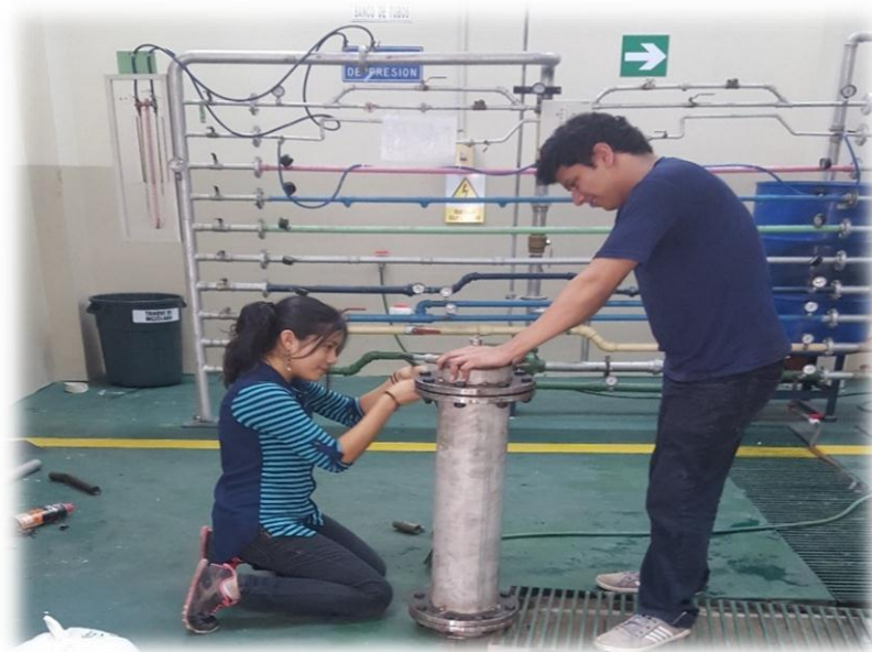
Figura 67. Pruebas para verificación de fugas en el Tamiz molecular Fuente: (Pactong, Solange; Salinas, Marcelo.)
