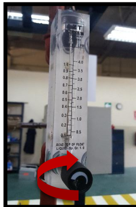
Figura 32. Controlador de flujo.
