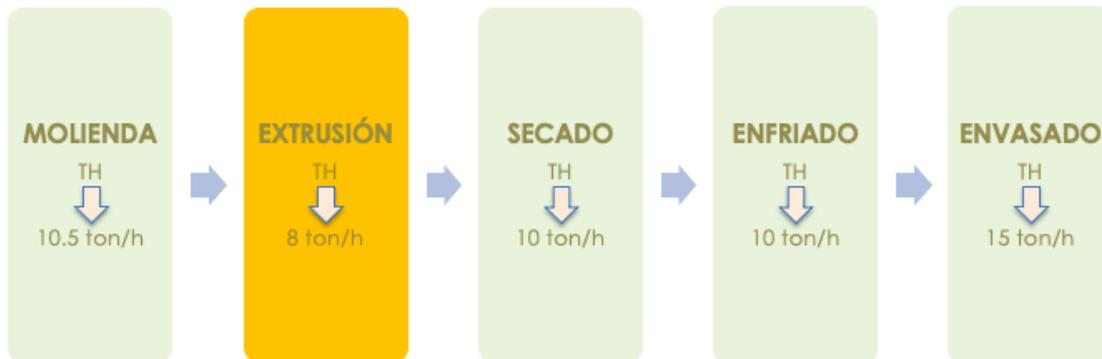
**Figura 2.11 Tasa de salida de cada proceso de la línea 12**
