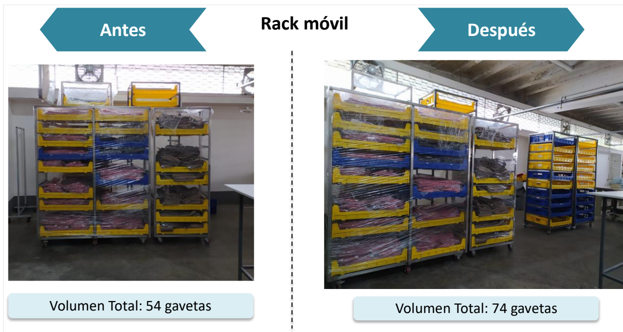
Figura 3.12 Rack móvil - Antes y Después (Elaboración propia)
