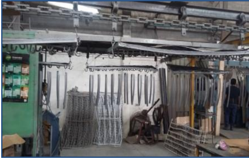
Figura 36: Pintado de manijas de puertas para hornos de cocinas
