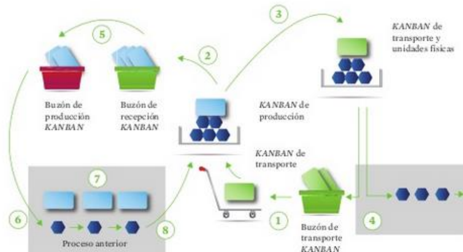
IMAGEN 2.4: ESQUEMA DEL SISTEMA KANBAN
