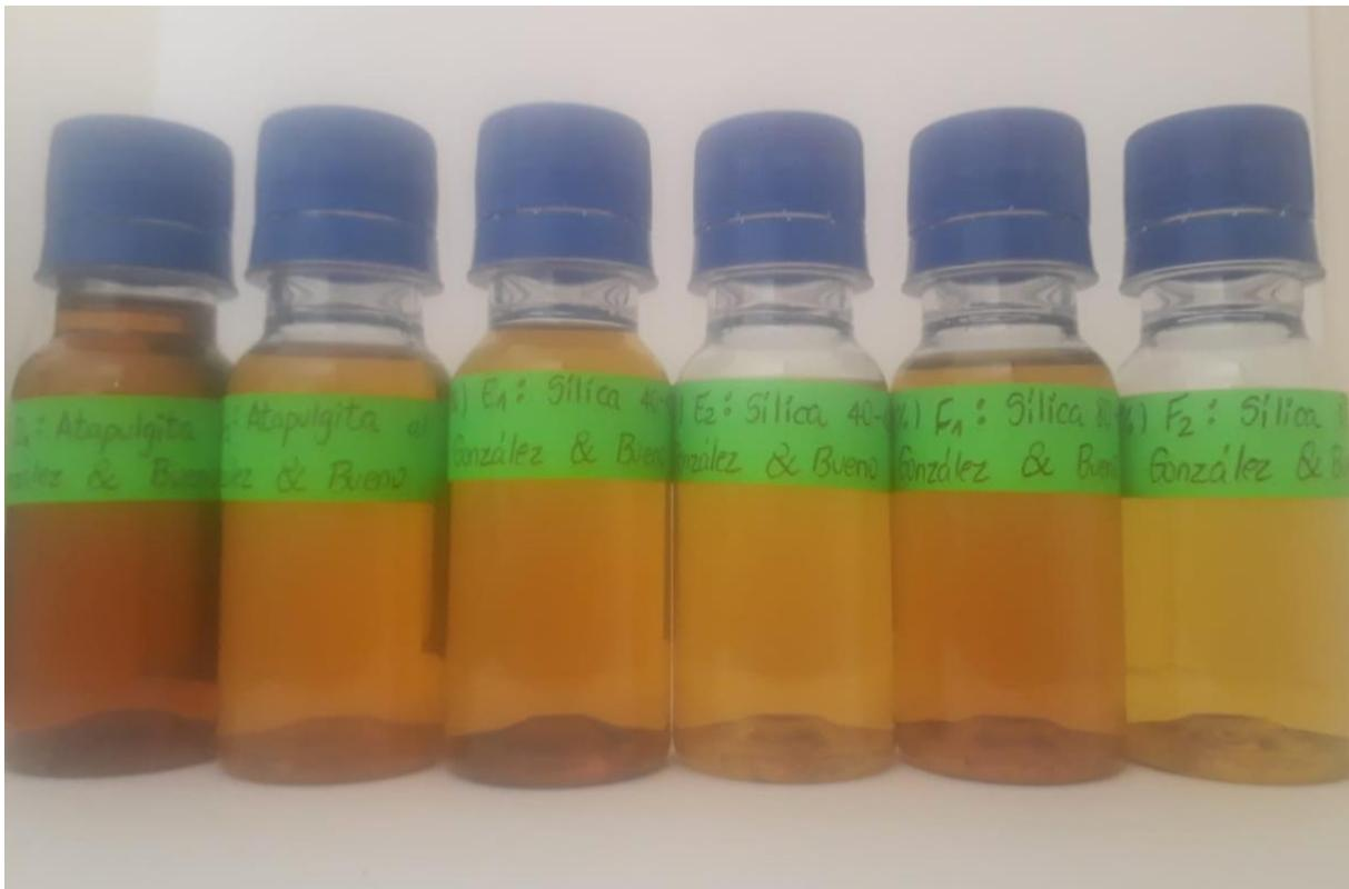
**Ensayos para la Muestra 2 (Original con concentración másica de ácido sulfúrico del 1 %)**
