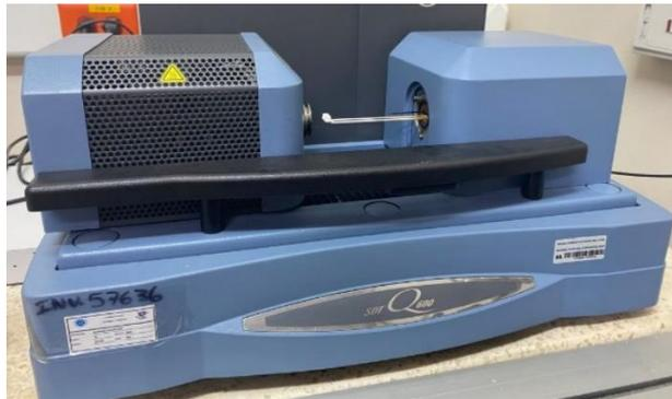
**Figura 2.7. Analizador térmico SDT Q600 marca TA Instruments**
