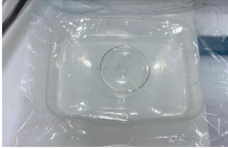
**Figura 2.2. Preparación de muestra de ácido oleico con técnica de flushing.**
