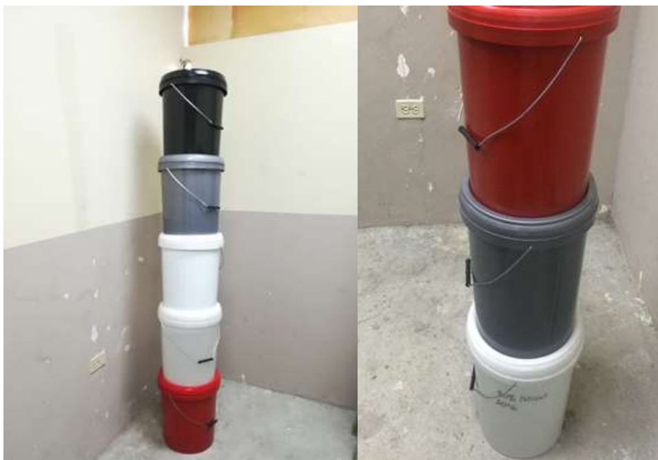
Figura 3.4 Prueba de Apilamiento de Baldes
