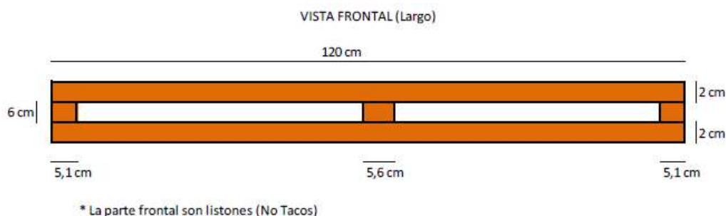
Figura 3.2 Vista frontal y dimensiones de un pallet de madera estándar
