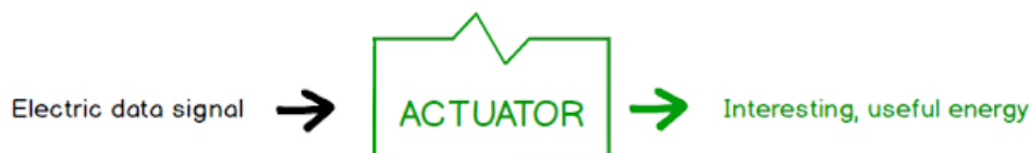
Figura 1.5 Función de los actuadores[13]
