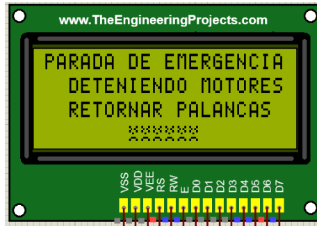
Figura 3.23 Pantalla de parada de emergencia
