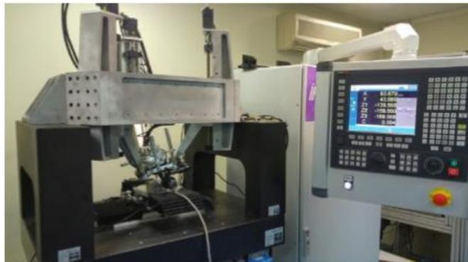
**Figura 1.1 Máquina herramienta CNC de configuración 3PRS + XY + C [4]**
