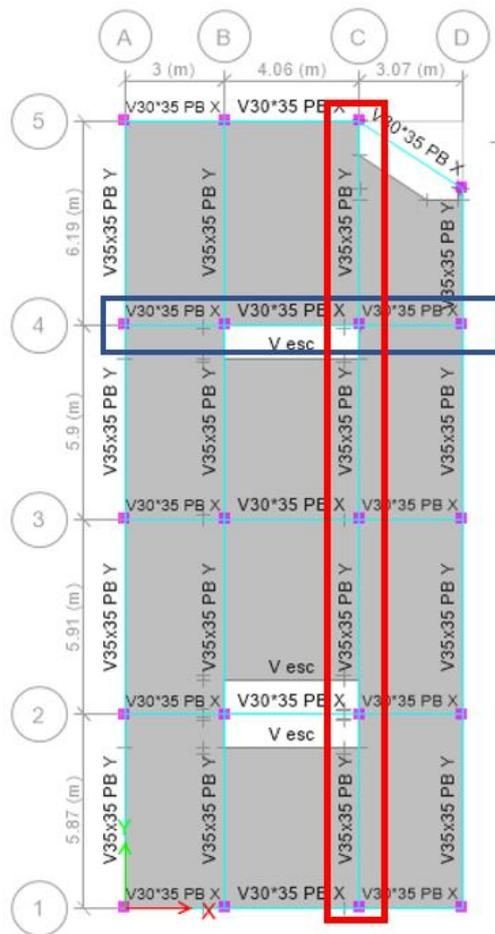
**Ilustración 87: Pórticos seleccionados en planta baja para el ejemplo del diseño de vigas a flexión. En azul pórtico 4 en dirección X; en rojo pórtico C, dirección Y.**
