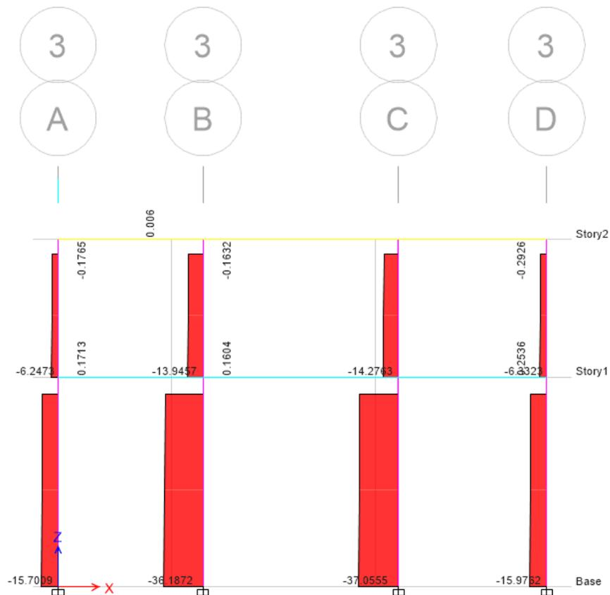
Ilustración 74: Carga axial máxima de servicio ( $D+L$ )
