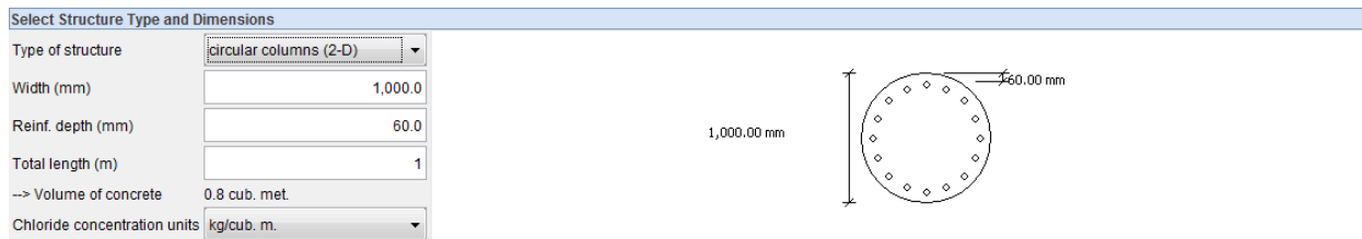
Figura 2.9.- Tipos de estructuras del software Service Life 365, [Elaboración propia, 2021]
