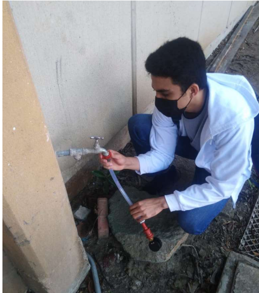
Figura 2.20. Toma de presión a las afueras de los laboratorios de FIEC [López & Zambrano, 2021].
