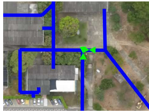
b) Colocación de nueva válvula de corte
