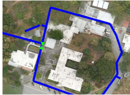
b) Colocación de nueva válvula de corte
