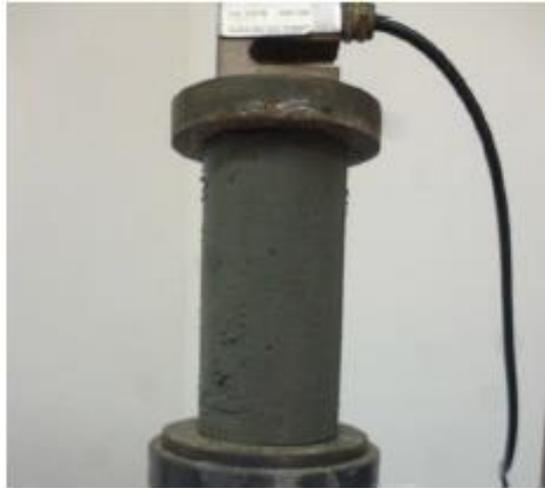
**Figura 8. Realización de ensayo de compresión**
