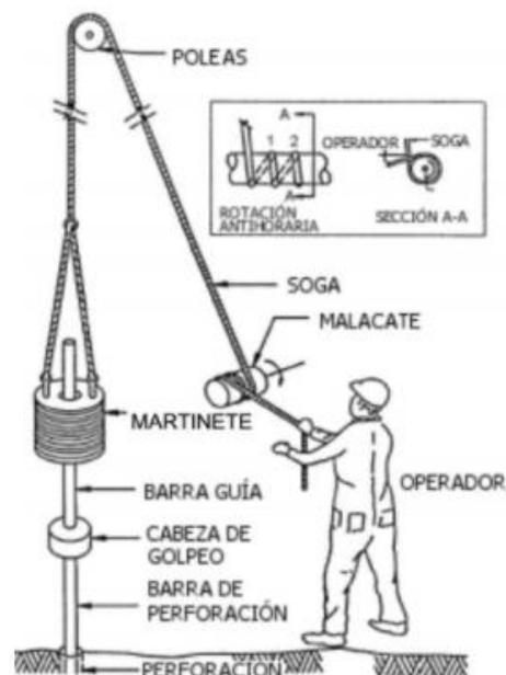
Figura 6. Esquema básico del sondeo a percusión. Fuente: R.E. López Menardi, 2003
