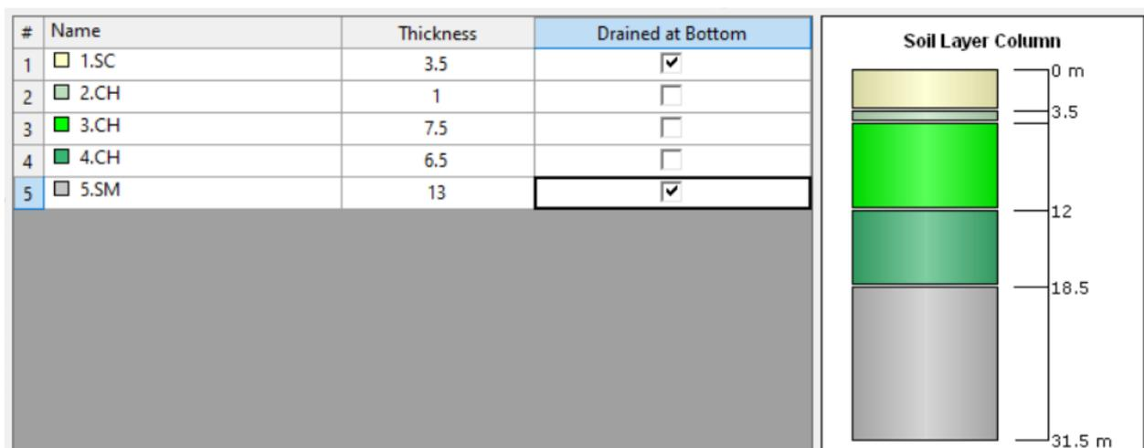
**Figura 25. Espesores de estratos utilizados Fuente: Autor**
