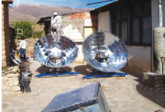
Figura 2.27. Cocina solar comunal con dos concentradores instalada en una escuela de la Puna a una altura superior a los 3000 msnm
