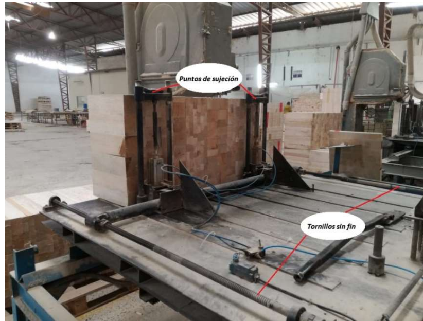
Figura 3.42 Puntos de sujeción y tornillos sin fin del equipo de corte
