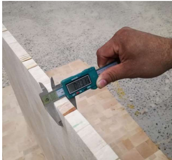
Figura 3.20 Medición del espesor de un panel
