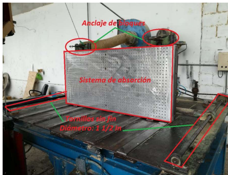
Figura 3.45 Equipo de corte mejorado
