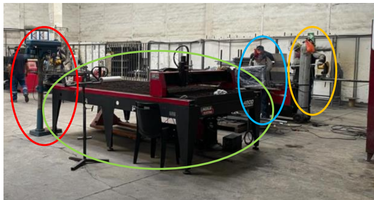
Figura 1.5 De izquierda a derecha se observa un taladro de pedestal (línea color rojo), máquina de corte (línea color verde), soldador MIG (línea color celeste), ayudante utilizando tronzadora de metal (línea color naranja). Fuente: Autor.
