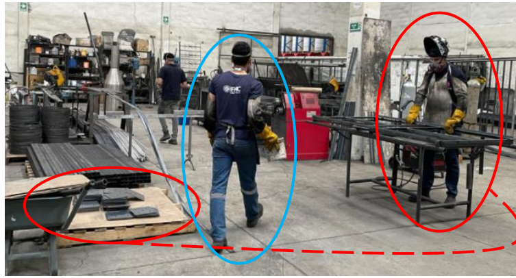
Figura 1.4 Soldador MIG 1, elaborando una CAMA ALIMENTADOR 1X2M (línea de color rojo), soldador MIG 2 yendo a buscar material cortado para soldar (línea color celeste). Fuente: Autor.
