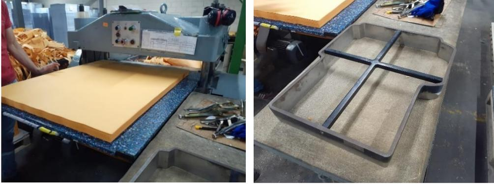
**Figura 2.5: Troqueladora y modelo de troquel.**
