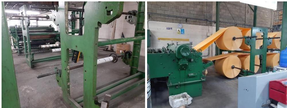
**Figura 2.2: Cortadora de bobinas de papel**
