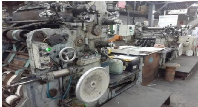
**Figura 2.7: Máquina conformadora de sobres W26G.**
