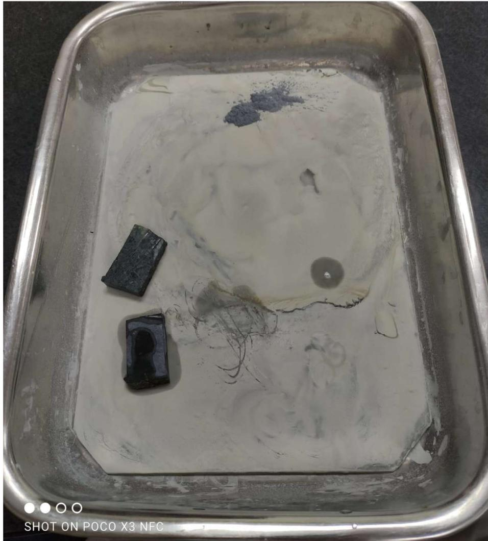
**Ilustración 4.8 Pulido de secciones delgadas con polvo abrasivo.**
