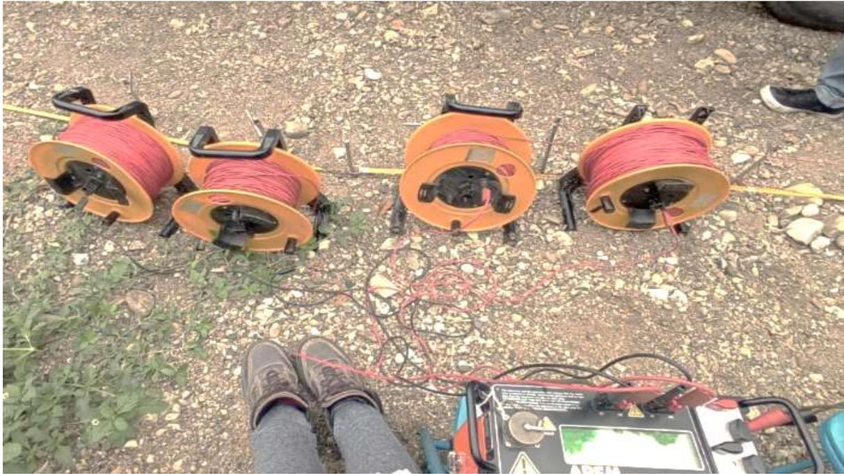
**Figura 3. 8. Equipo geoelectrico para realización de SEVs.**
