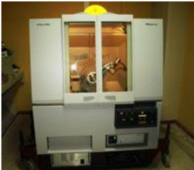
**Figura 3.4 DIFRACTÓMETRO DE RAYOS-X**
