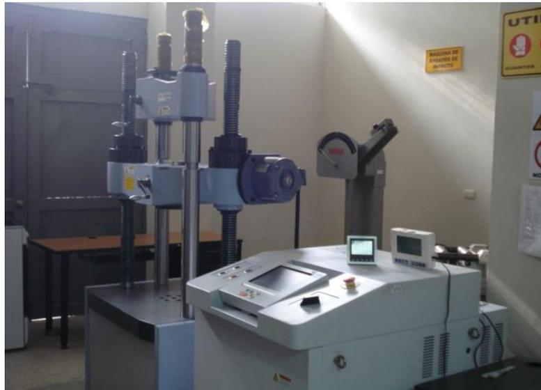
**Figura 3.2 MÁQUINA UNIVERSAL DE ENSAYOS**
