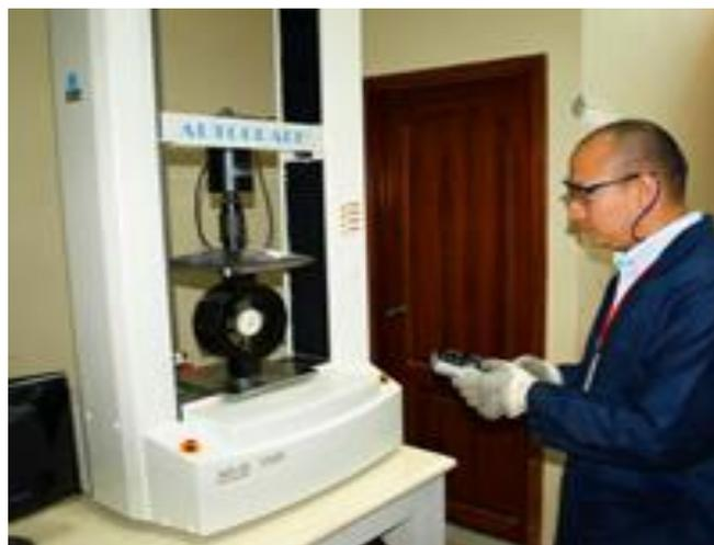
**Figura 3.3 MÁQUINA UNIVERSAL DE ENSAYOS PLÁSTICOS**
