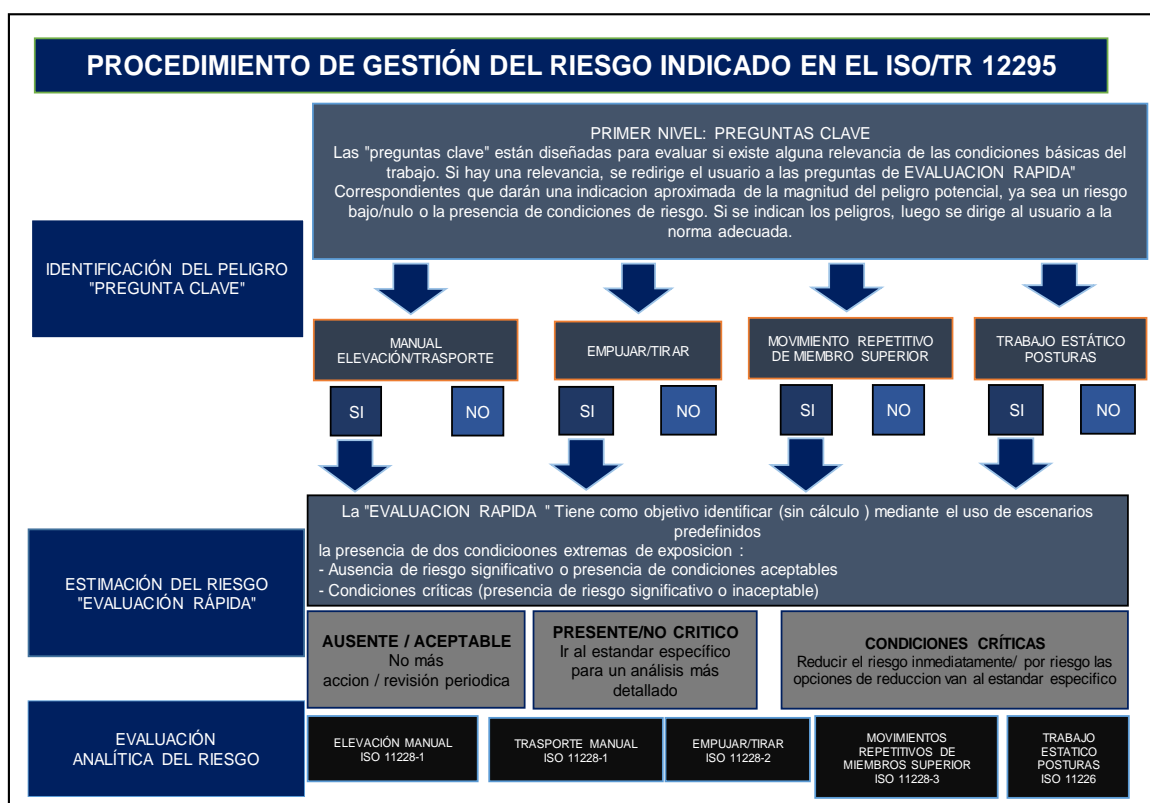
Figura 3.1 Procedimiento de gestión del riesgo ISO/TR 12295
