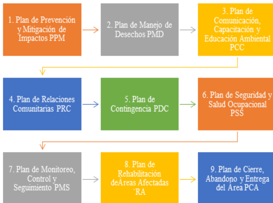
Ilustración 2-9 Estructura de un Plan de Manejo Ambiental (PMA). Fuente: (Secretaría de Ambiente, 2017)
