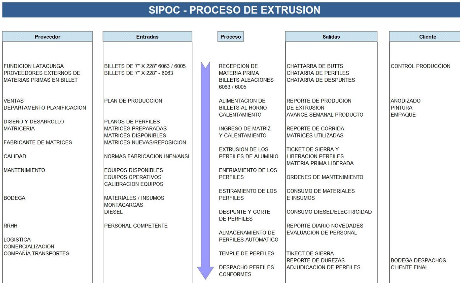
Figura 2.6 Diagrama SIPOC - proceso de extrusión
