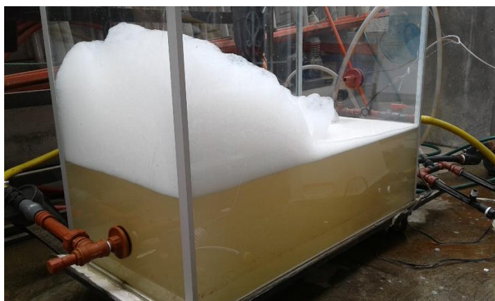
Figura # 5.60 Pruebas de eliminación de sólidos suspendidos.
