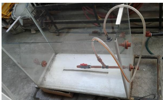
Figura # 3.24 Tanque rectangular para el sistema piloto
