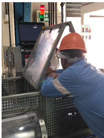
Figura 2.9. Calibración de la máquina chequeadora de peso
