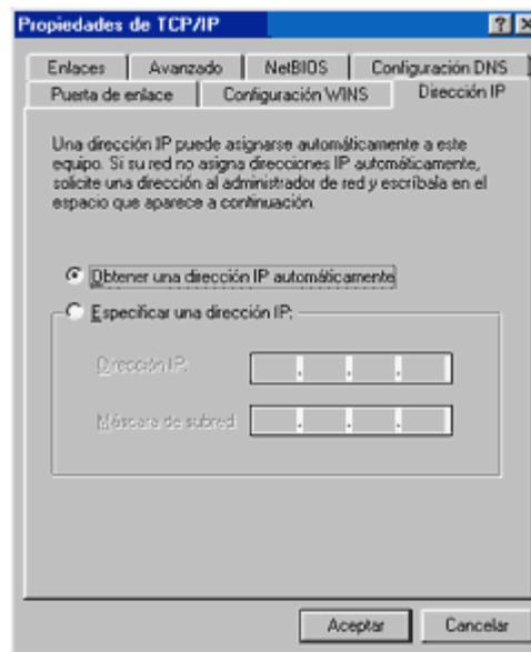
Figura 6-17 Obtención de dirección IP mediante DHCP (W98)
