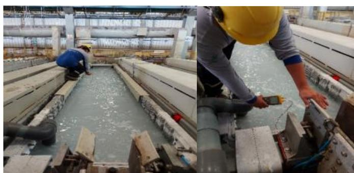
**FIGURA 4.27 MEDICIÓN DE TEMPERATURA EN DIFERENTES PUNTOS DEL NATURAL**
