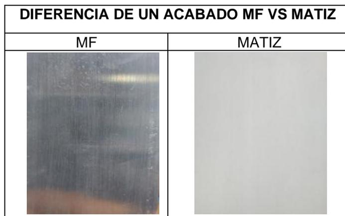
**FIGURA 3.6 DIFERENCIA DE UN PERFIL EN MF Y MATIZADO**
