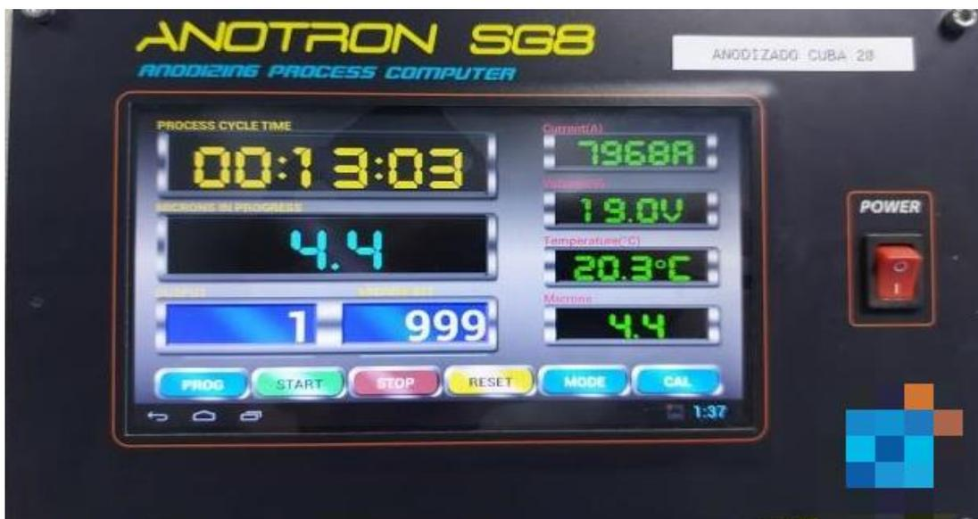
**FIGURA 4.11 ANOTRON SG8 PARA CONTROL DE ESPESOR DE CAPA ANÓDICA.**
