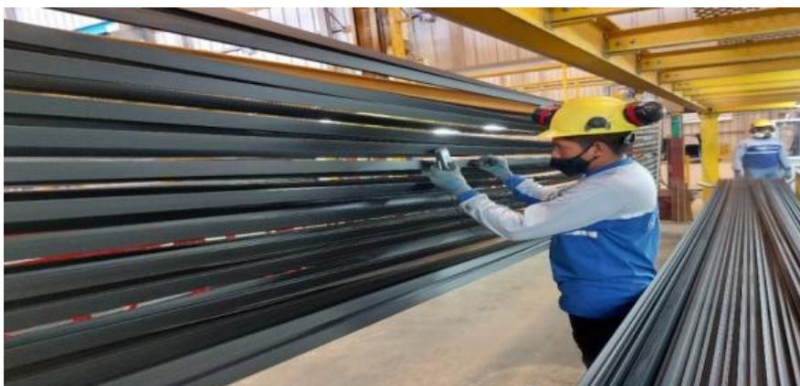
**FIGURA 3.13 VERIFICACIÓN DEL ESPESOR DE CAPA ANÓDICA**
