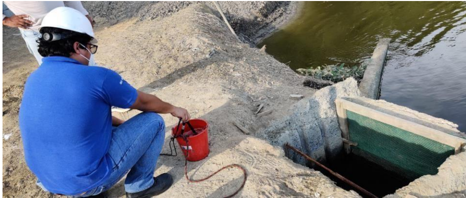
Ubicados en la compuerta de salida de agua, tomando la muestra para proceder con el análisis de calidad de agua
