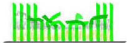
**- Tendido de la fibra:** La fibra plástica de césped, en origen, se permanece vertical. El uso del campo, el paso del tiempo, la acción de los agentes atmosféricos acaban por tumbar esta fibra.
