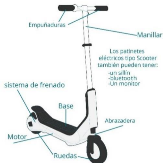
Figura 1.8 Componentes de un scooter eléctrico Fuente: Partes del scooter eléctrico (iTecnotoys, 2018)
