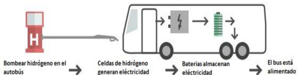
Figura 1.4 Esquema general de carga de un bus eléctrico con celdas de hidrógeno Fuente: Electric Bus Technology - Final Report (p.11), (MRCagney, 2017)
