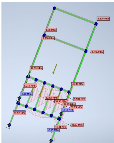
Figura 3.3 Máximos esfuerzos en las vigas del soporte
