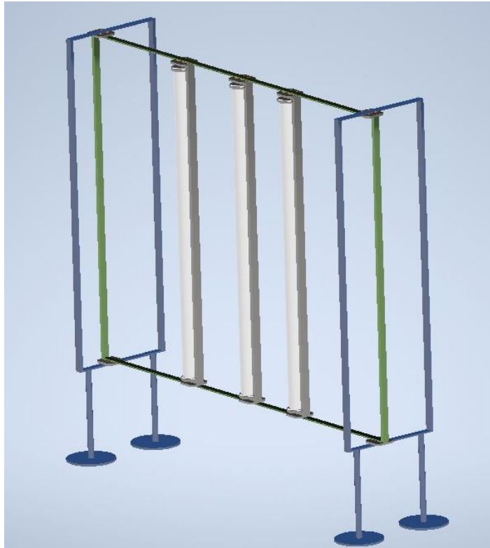
Figura 3.7 Panel de luz con el sistema de riel
