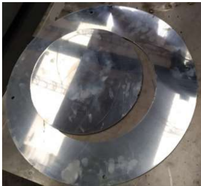
Figura 3.4 Vista final de la placa caliente y placa de guarda.
