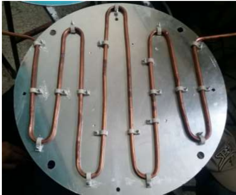
Figura 3.7 Vista interior de la Placa Fría con el intercambiador de calor.
