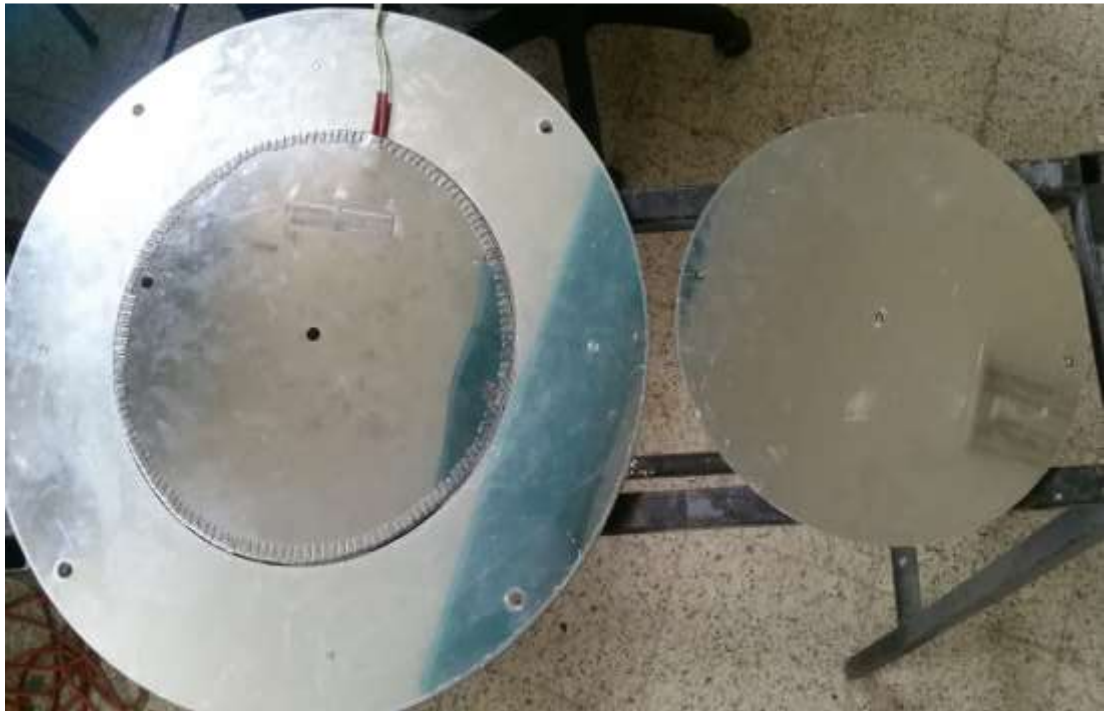
Figura 3.5 Acoplamiento de la resistencia térmica en la placa caliente con la placa de guarda.
