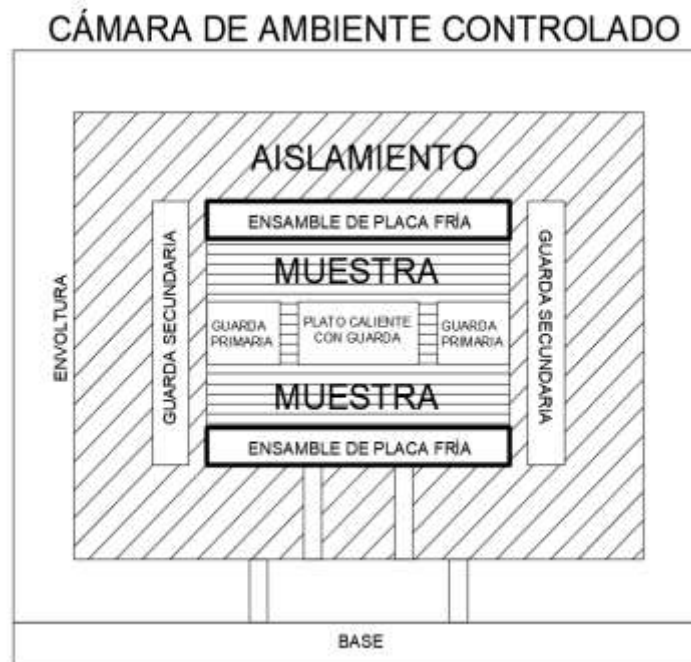
Figura 1.1 Vista general de los componentes mecánicos del aparato de placa caliente con guarda. [28]
