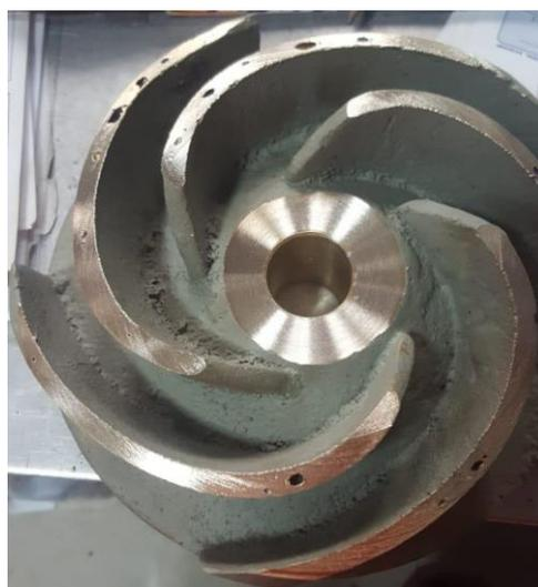
**Figura 4.20 Impeller Maquinada [Elaboración propia]**
