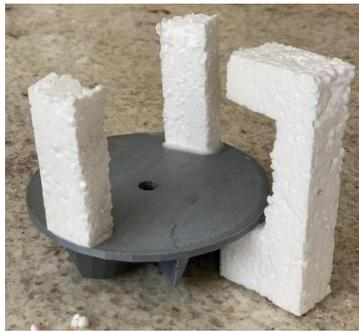
Figura 4.7 Colocación del vertedero y mazarota [Elaboración propia]
