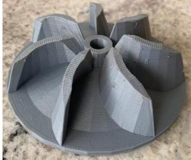
Figura 4.6 Impeller impreso en 3D [Elaboración propia]
