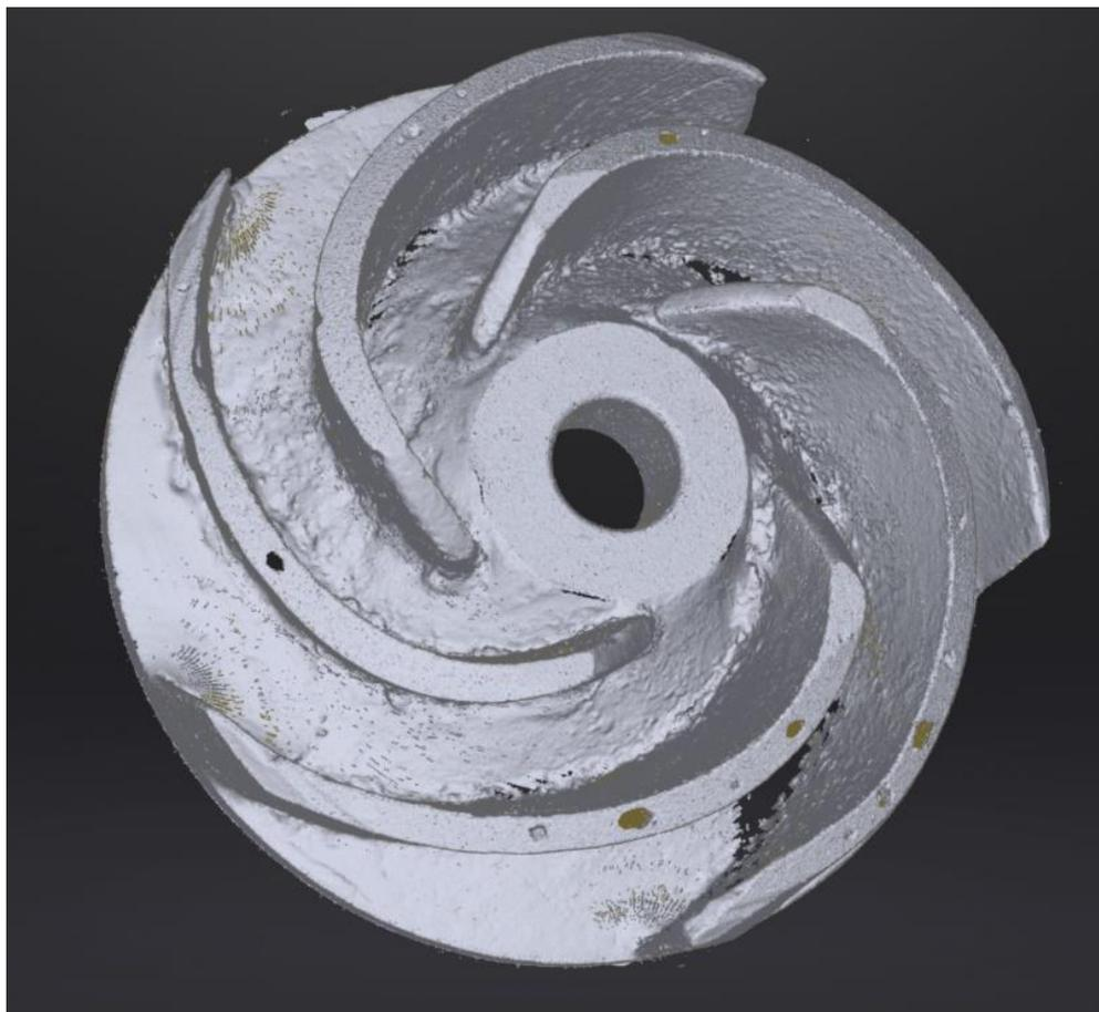
**Figura 2.26 Mallado del impeller B para obtener el CAD final [Elaboración propia]**
