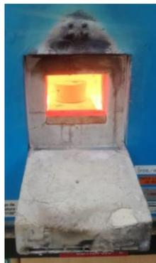
Figura 4.13 Estufa horno de sinterización [Elaboración propia]
