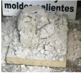
**Figura 4.15** Cristalización del molde por transferencia de calor [Elaboración propia]
