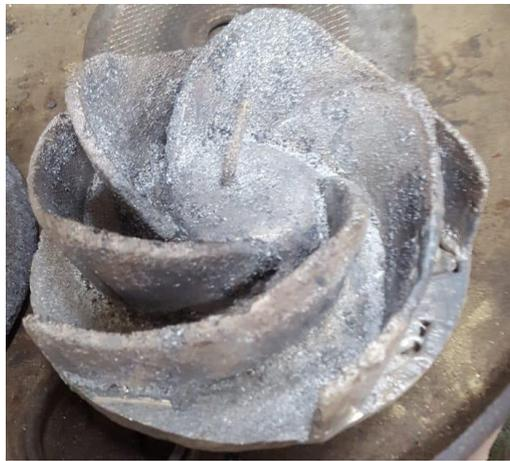
**Figura 4.19 Impeller Fundido [Elaboración propia]**
