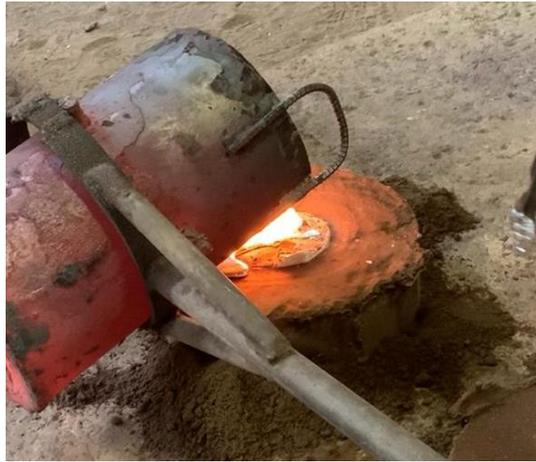
**Figura 4.18 Vaciado del Metal fundido [Elaboración propia]**
