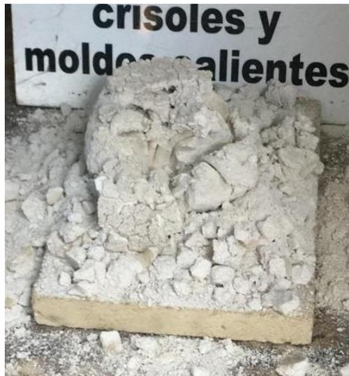
**Figura 3.3 Molde de yeso después de estar en horno [Elaboración propia]**
