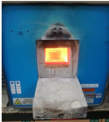
**Figura 2.29 Fundición del modelo plástico con estufa [Elaboración propia]**
