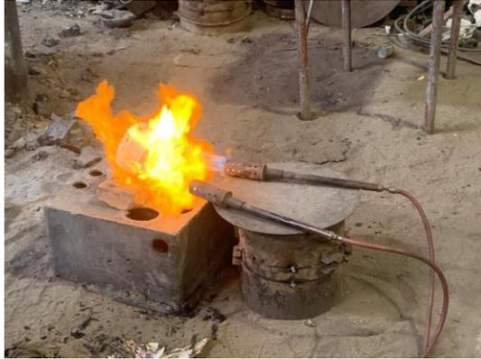
**Figura 2.28 Fundición del modelo plástico con directo con soplete [Elaboración propia]**
