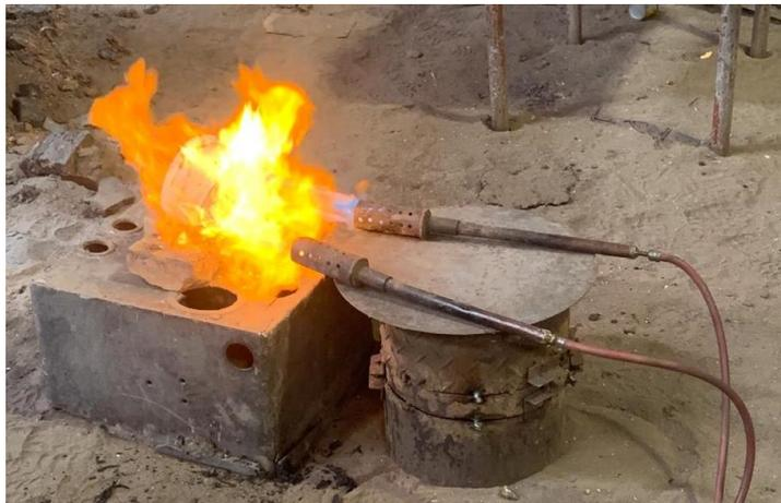
Figura 4.17 Proceso de derretimiento del material plástico [Elaboración propia]
