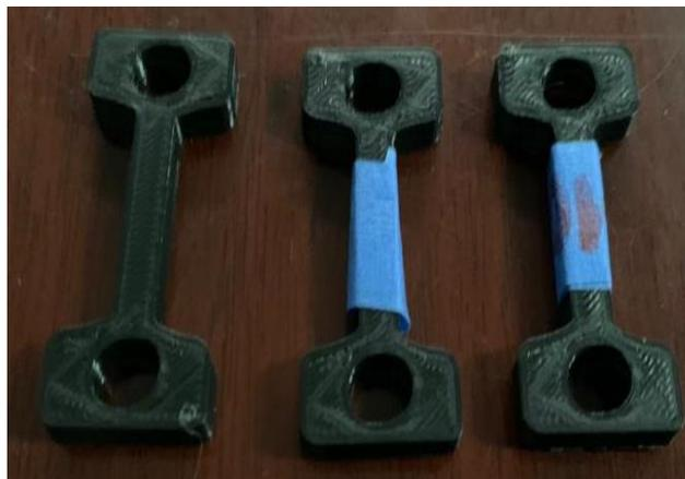
**Figura 2.7 Probetas impresas en 3D para determinar la contracción por solidificación**
