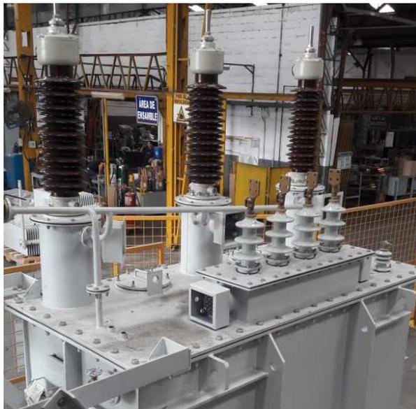
**Figura 1.5. La tapa contiene los bushings de las 3 fases del transformador. [Moretran, 2019]**
