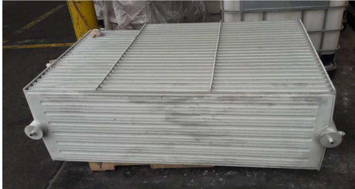
**Figura 1.8. Sistema de refrigeración por radiación y convección natural. [Moretran, 2019]**
