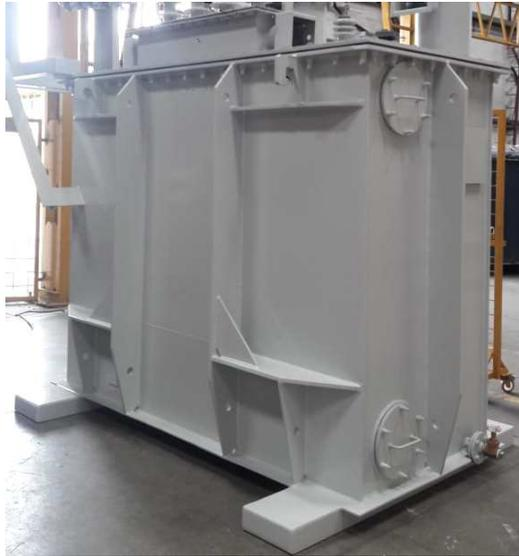
**Figura 1.4. Los refuerzos estructurales cruzan vertical y horizontalmente parte de la cuba. [Moretran, 2019]**
